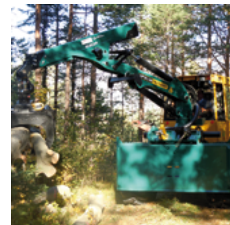
Forstraktor HSM 805: 150 PS, funktfern-gesteuerte Seilwinde mit 2 x 10 Tonnen Zugkraft, Rückekran für 1 Tonne Last bei einer Reichweite von 6,8 m.
