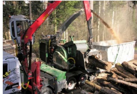
Oben: Das Energieholz wird im Wald zu Hackgut verarbeitet und direkt zum Verbraucher transportiert.
